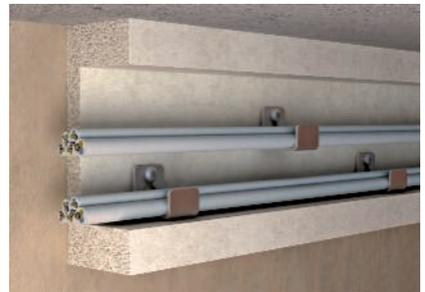
Kabelmontage mit Trennwinkel und Trennbügel
