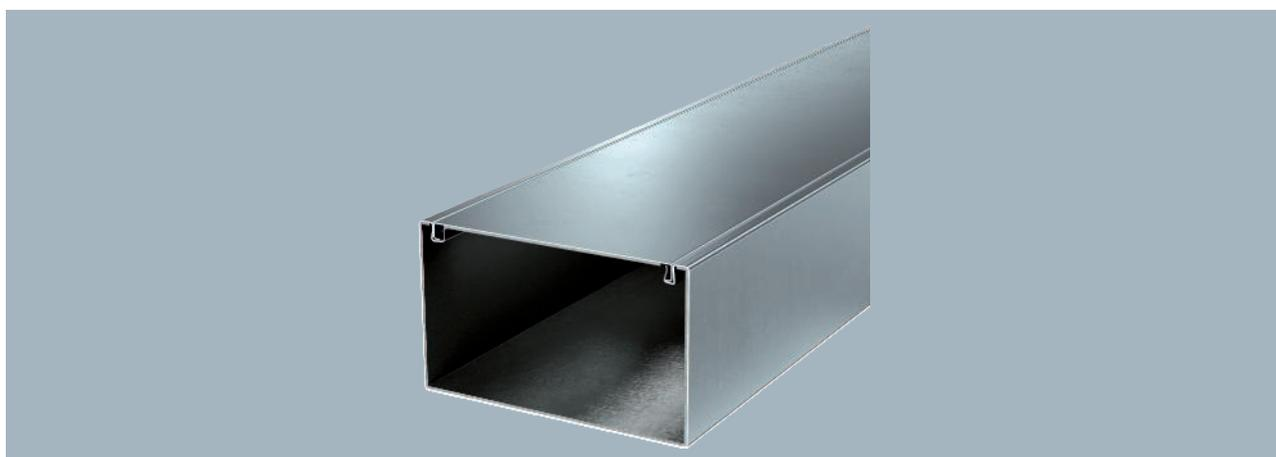
Installationskanal aus Metall mit intumeszierendem Brandschutzgewebe zur brandsicheren Verlegung von Kabeln. Klassifiziert als Installationskanal EI30, EI60 und EI90 gemäß EN 13501-2, geprüft nach EN 1366-5. Der Kanal verhindert über den klassifizierten Zeitraum die Brandweiterleitung und schützt vor den Auswirkungen eines Kabelbrandes.
