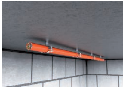
Montage unter der Decke.
