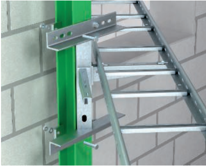
Adapterplatte 45°, Stahlklemmung Montage der Adapterplatte 45° Typ KA-E 45 an Stahlträger mittels Klemmwinkeln oder Spannpratzen. Zur zusätzlichen Unterstützung bei Trassenverläufen an Winkeln und Raumecken.
