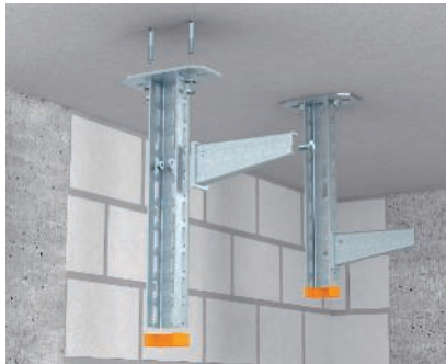
Standardmontage Hängestiel mit Wandausleger einseitig ohne Distanzstück Deckenbefestigung eines Hängestiels mit einseitiger Auslegerbefestigung. Bis einschließlich Breite 300 mm ist teilweise kein Distanzstück erforderlich.
