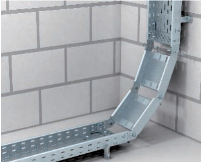
Montage Gelenkbogen vertikal steigend Gelenkbogen vertikal steigend zur Überbrückung von Höhenversätzen. Der Gelenkbogen wird mit Gelenkverbindern an der Kabelrinne montiert.
