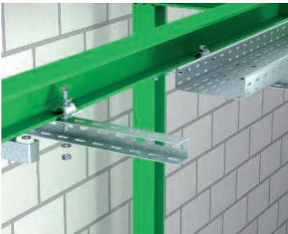
Kabelrinnenmontage an Stahlträger Kabelrinnenmontage mit Spannklaue des Typs TKS-L-25 und U-Stielen als Kragträger an Stahlträgern. Zur sicheren Funktion sind Distanzstücke Typ DSK einzusetzen.
