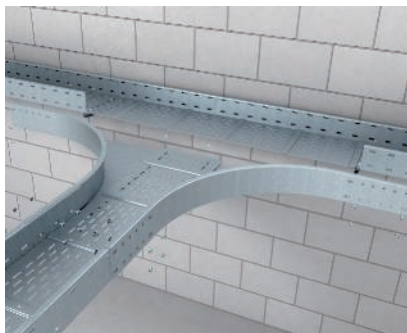
Herstellung eines T-Abzweigs mit Eckanbau-Stück Montage des fertigen Abzweiges an die durchgehende Weitspannkabelrinne.
