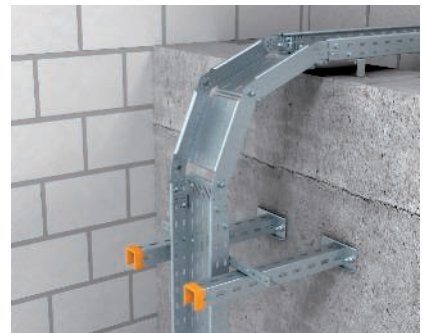
Montage Gelenkbogen vertikal fallend Gelenkbogen vertikal fallend zur Überbrückung von Höhenversätzen. Der Gelenkbogen wird mit Gelenkverbindern mit der Kabelrinne verbunden.
