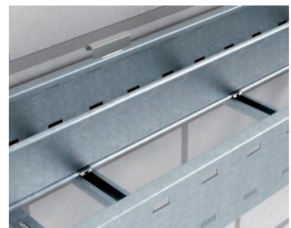
Trennsteg-Längsverbindung Schraubenlose Längsverbindung von Trennstegen in Weitspannkabelrinnen und -kabelleitern mithilfe des Trennstegverbinders TSGV.
