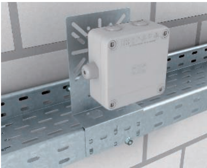
Montageplatte mit Schnellbefestigung Befestigung der Montageplatte Typ MP an der Kabelrinne. Die Montageplatte kann mit Schnellbefestigungen am Holm fixiert und mit Flachrundschrauben Typ FRS B dauerhaft befestigt werden.
