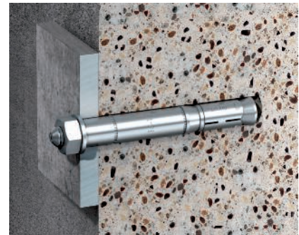
Schwerlastanker Typ SZ Schwerlastanker Typ SZ mit Gewindeanschluss M12, zur Befestigung von Bauteilen mit großen Belastungen, zugelassen für gerissenen und ungerissenen Normalbeton C20/25 bis C50/60.
