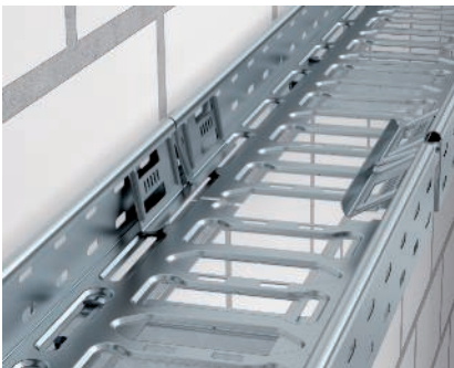
Montage Längsverbinder-Set Magic KTSMV Einfach die beiden Seitenteile des Verbinder-Sets in den Seitenholm einklemmen.
