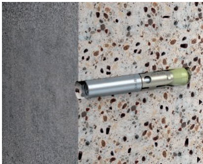
Bolzenanker Typ BZ-IG Der Bolzenanker BZ-IG mit Innengewinde ist für normale, nicht hinterschnittene Bohrlöcher bauaufsichtlich zugelassen. Im Rahmen der Europäischen Technischen Zulassung ETA-99/0010 für gerissenen und ungerissenen Beton können außer Sechskantschrauben auch Senkkopfschrauben sowie ein System aus Mutter und Scheibe und einer handelsüblichen Gewindestange verwendet werden.
