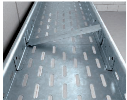
Schraubenloses Langsverbinder-Set RV Die zugehorige Stostellenleiste nach unten drucken, bis es eingerastet ist.
