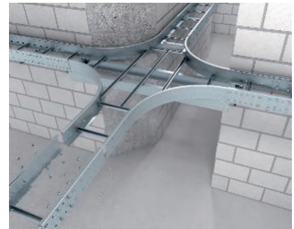
Montage Kreuzung Kreuzung in Kombination mit Weitspannkabelleiter. Die Kreuzung wird mit Außenverbindern mit der Weitspannkabelleiter verbunden.
