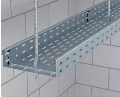
Anwendung Mittenabhangung Mittenabhangung der Kabelrinnen-Systeme MKS, SKS, EKS, DKS und IKS mit der Mittenabhangung Typ MAH und Gewindestange 2078/M10.
