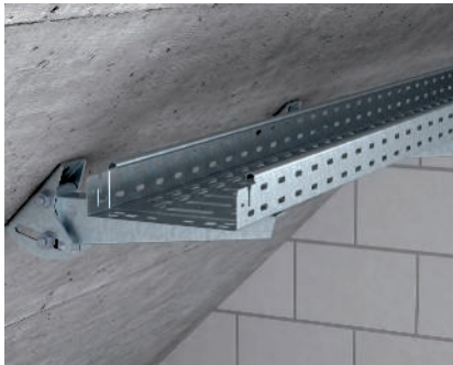
Wandausleger variabel Befestigung des variablen Wandauslegers Typ AWW mit Bolzenanker an gewölbten oder schrägen Wänden/Decken.
