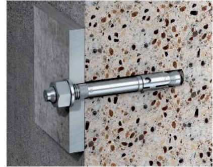
Bolzenanker Typ BZ Bolzenanker Typ BZ, zur Befestigung von Schwerlastverankerungen in gerissenen oder ungerissenen Normalbeton C20/25 bis C50/60, für Durchsteckmontage geeignet, mit Anschlussgewinde M8, M10 oder M12.
