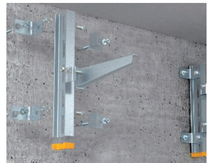
Wandbefestigung I-Stiel Montage eines I-Stiels an der Wand mittels Befestigungswinkeln Typ BW 80/55 und Bolzenankern zur Aufnahme mehrerer Stielausleger Typ AS.
