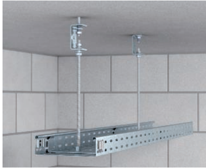
Montage Mittenabhängung Montage der Mittenabhängung MAH 60 mit Gewindestange 2078/M10 und Deckenbügel 12050 an der Decke. Maximale Kabelrinnenbreite 300 mm.
