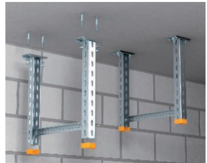
Traverse Montage von U-Hängestielen US 3 K, US 5 K und US 7 K unter der Decke mittels Bolzenanker und Einsatz einer Quertraverse, bestehend aus U-Profil US 3, US 5 oder US 7.
