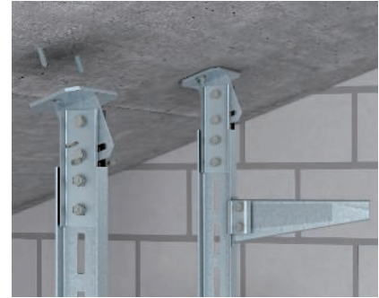
Kopfplatte variabel (90° gedreht) Montage der variablen, um 90° gedrehten Kopfplatte Typ KI 8 VLK an schräger Betondecke mit Bolzenankern.
