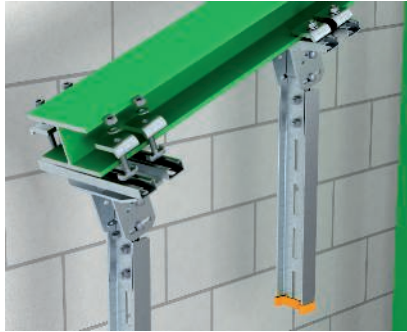
Anwendung am schrägen Stahlträger Klemmbefestigungen mittels Klemmwinkeln und Spannklauen an schräg verlaufenden Stahlträgern.
