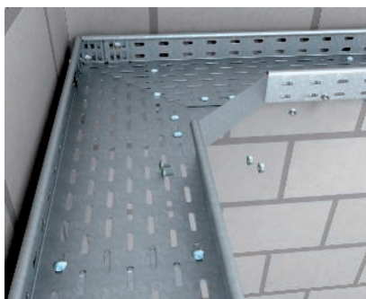
Bogenerstellung mit Eckverbinder Bei bauseits zu erstellenden 90-Bogen kann zur Vergroerung des Innenradius der Eckverbinder Typ REV eingesetzt werden.
