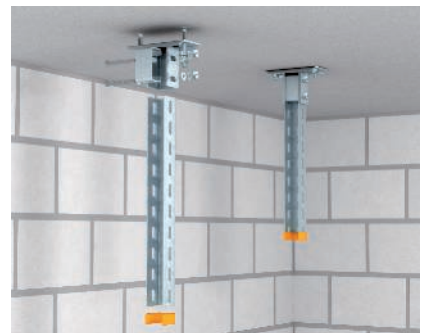
Kopfplattenmontage Montage der Standardkopfplatte an Stiel und Decke. Einsatz mit Distanzstück DSK 25 (US 3), DSK 45 (US 5) oder DSK 61 (US 7).
