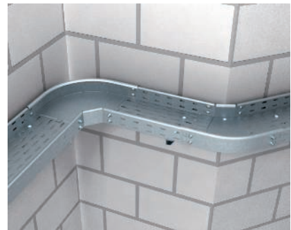
Montage Bogen (Breite 100 - 300 mm) Der Bogen in den Breiten 100 bis 300 mm wird einseitig in den Holm und auf der anderen Seite über den Verbinder geschoben. Im Bereich der Formteile sollten weitere Unterstüzungen vorgesehen werden.
