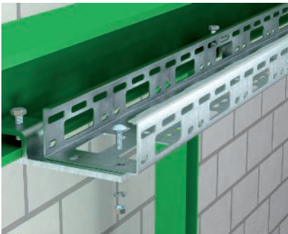
Klemmbefestigung waagrecht Montage AZ-Kleinkanal mit Befestigungsklemme BFK längs an Stahlträger. Maximale Kabelrinnenbreite 100 mm.
