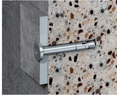
Nagelanker Typ N-K mit Einschlagkopf Nagelanker Typ N-K mit Einschlagkopf, einsetzbar in gerissenen oder ungerissenen Normalbeton C20/25 bis C50/60.
