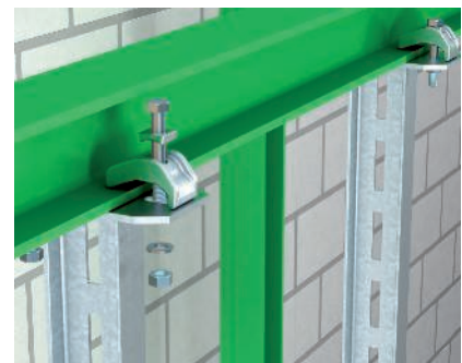
Direkte Stahlklemmung Direkte Stahlklemmung eines I-Hängestiels mittels schwerer Spannklau TKS-S-30. Trassenverlauf in Längsrichtung des Stahlträgers.
