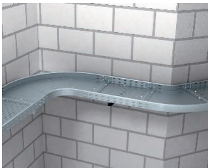
Montage Bogen (Breite 400 - 600 mm) Der Bogen in den Breiten 400 bis 600 mm wird mit Verbindern und Stoßstellenleiste mit der Kabelrinne verbunden. Im Bereich der Formteile sollten weitere Unterstüzungen vorgesehen werden.
