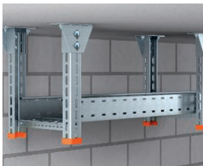
Montagebeispiel Doppelseitige Hängestielmontage aus U-Profilen mit Quertraverse. Befestigung einer Weitspannkabelrinne Typ WKSG 110 mit Flachrundschräuben auf dem Querprofil.
