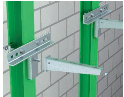
Klemmbefestigung an senkrechtem Stahlträger Montage der Adapterplatte Typ KA-AW an senkrechtem Stahlträger mittels Klemmwinkeln oder Spannpratzen. An der Adapterplatte werden Wandausleger Typ AW mit der Sechskantschraube Typ SKS 12x40 GF befestigt.
