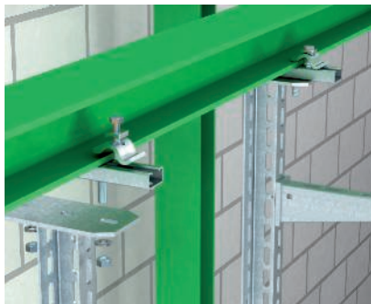
Klemmbefestigung mit zusätzlichem C-Profil Einsatz einer zusätzlichen C-Profilschiene Typ MS bei breiteren Stahlträgern. Trassenverlauf längs zum Stahlträger.
