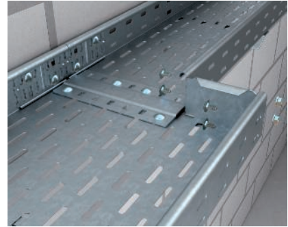
Einbau Reduzierwinkel und Endabschlussblech Das Bauteil Reduzierwinkel und Endabschlussblech wird als Abschluss und zur Breitenreduzierung von Kabelrinnen eingesetzt.
